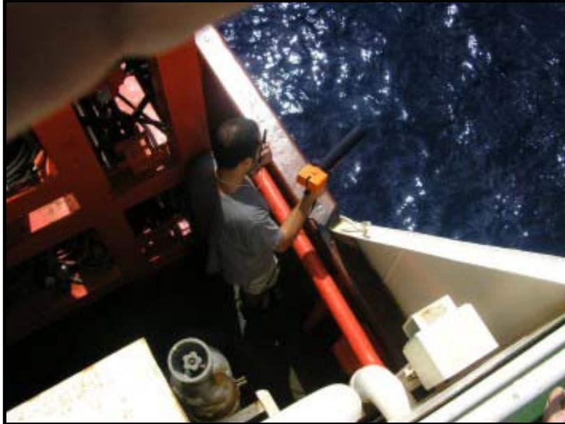
**Figura 18.** Lanzamiento de un batitermógrafo desechable o XBT.
