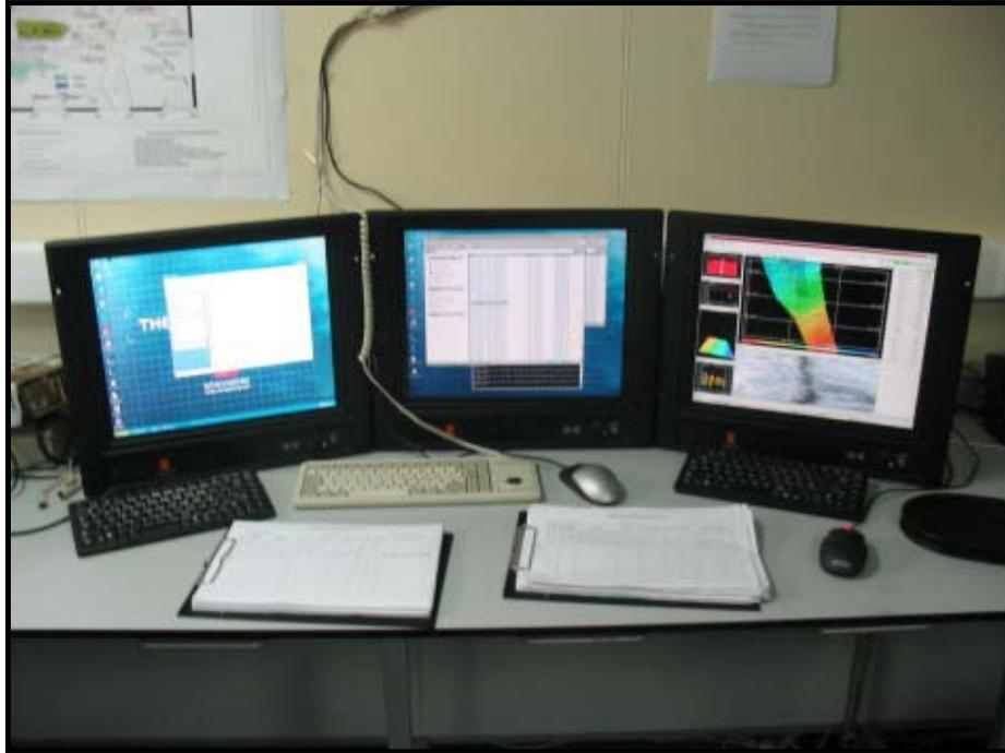
**Figura 20.** Unidad de adquisición y control en tiempo real de la ecosonda multihaz.
